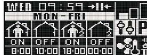
Пример запрограммированного календаря (рабочие дни). Устройство будет включено в 8:00 и будет выключено в 10:00. Устройство снова включится через 6 часов в 18:00 и проработает до 00:00. Данные настройки распространяются на рабочие дни с понедельника по пятницу.
